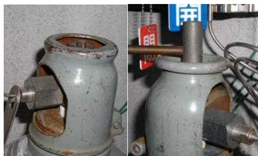
図 1.5.4 ボンベヘッドの構造
