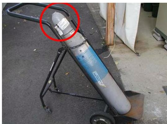
図 1.5.1 ポンベの運搬方法
