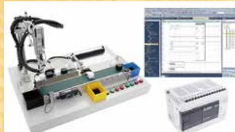
PLCによるハンドロボットの生産ライン自動制御
