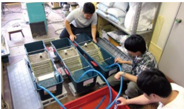
鉄鋼スラグで堤防盛土モデルを製作し、透水量やpHを測定中
