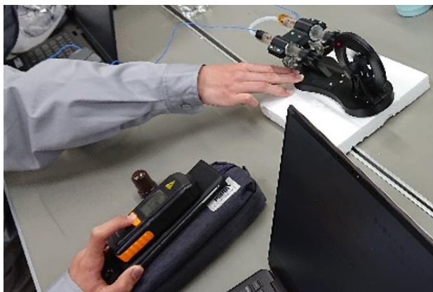
図2 デジタル回転数計でγ型エンジンの回転数を計測
