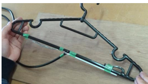
図2 ハンガーを使ったアンテナの外観
