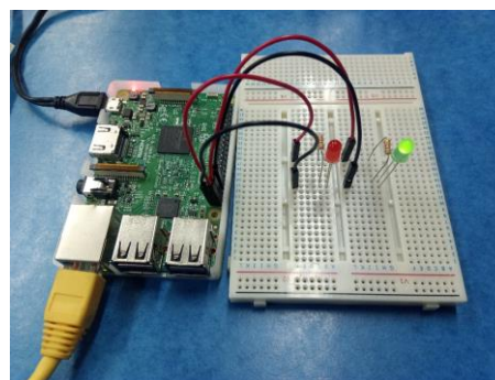
図2 GPIO を用いた LED 点灯制御
