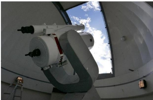
図1 口径60cmカセグレン式反射望遠鏡
